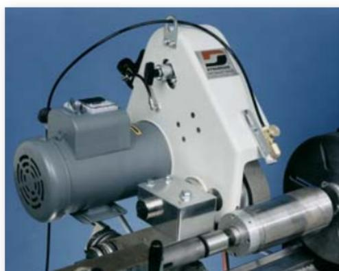
Машина для шлифовки валов с электроприводом
