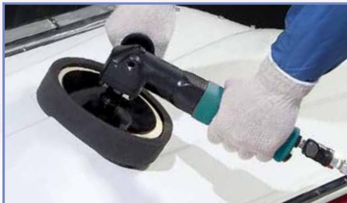
**La pulidora Dynabrade 51459** se usa para pulir y para acabados finales. Trabaja a la velocidad óptima de 2.500 RPM, lo que significa que esta pulidora en realidad está eliminando las rayas; NO las funde en la superficie, como hacen con frecuencia las pulidoras más rápidas. ¡Use nuestra pulidora de baja velocidad y un alto par con una boina de espuma o de lana (se vende por separado) y tendrá un sistema rápido y eficiente para sus acabados!
