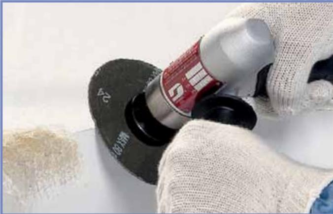
La lijadora de disco 50321 con empuñadura de pistola quita con facilidad el exceso de fibra de vidrio. También se usa para el desbaste de la superficie de resina del barco, y prepararla para una adhesión correcta de la capa exterior.
