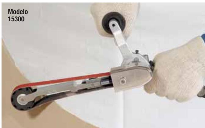
Dynafile® III adaptada con brazo de contacto 15375 (se vende por separado) para acabados con la banda. Para este brazo se requiere una banda de 610 mm (24") de longitud
