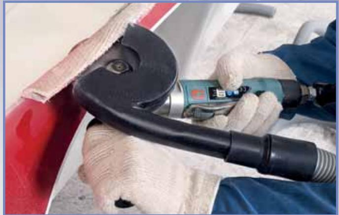
La herramienta cortadora de disco adiamantado 52438, con aspiración, acciona discos de corte adiamantados de 127 mm (5") de diámetro (se venden por separado), para proporcionar cortes agresivos a través de envolturas de fibra de vidrio y de aspersiones de fibra gruesas. Su protector exclusivo desvía el polvo y los desechos hacia una fuente opcional de aspiración.
