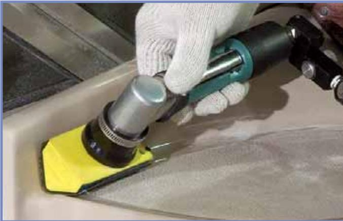
La lijadora Dynafine™ 58000 de "rincones", viene con plato lijador de 10 mm (3/8") de radio, ideal para llegar a esquinas, ranuras y superficies cóncavas. Se usa para lijado fino, retoque de pintura de "gel-coat" y para reparaciones locales en general – ¡una herramienta útil en cada instalación náutica!
