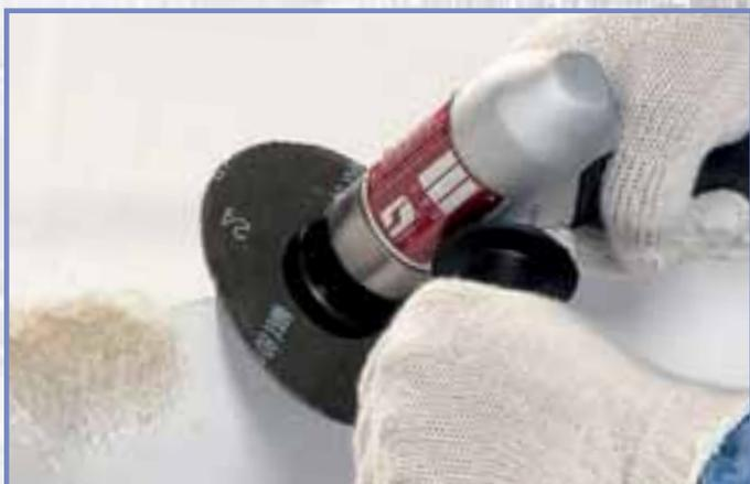
**50321** La levigatrice a disco con impugnatura a pistola elimina facilmente la fibra di vetro in eccesso. Questo utensile viene utilizzato anche per la levigatura di rigature sulle superfici di resina, preparandole per assicurare la giusta adesione della schiuma di galleggiamento.
