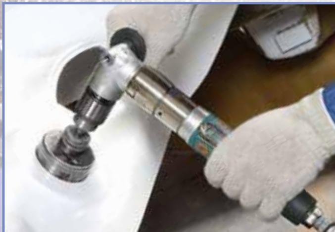
**53143** Il trapano a 90° ha la potenza necessaria (1 hp / 746 W) per far funzionare seghe a tazza diamantate (optional), per ottenere velocemente fori sulle sagome per cruscotti o altre aperture.
