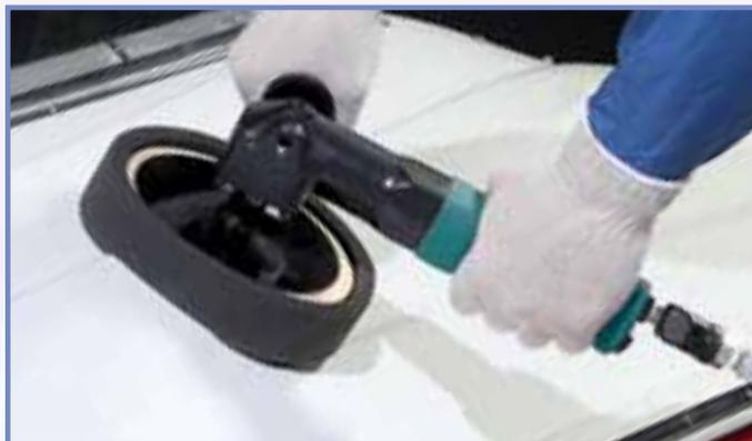
**51459** La lucidatrice Dynabrade è ideale per una lucidatura efficace e per la rifinitura finale. La lucidatrice funziona alla velocità ottimale di 2.500 giri, per eliminare lucidando, i segni di levigatura senza danneggiare la superficie. Utilizzate la nostra lucidatrice a bassa velocità e coppia elevata con tampone in spugna o in lana (venduti separatamente) per un sistema di finitura rapido ed efficiente!
