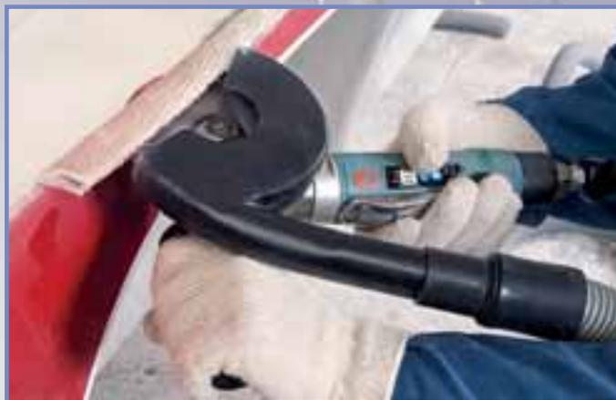
**52438** L'utensile mola da taglio diamantata con aspirazione permette l'uso di mole da taglio diamantate (in vendita separatamente) del diametro da 127 mm (5") per eseguire tagli impegnativi di strati spessi di fibra di vetro. L'esclusiva cappa di aspirazione, collegabile ad un aspiratore, elimina la polvere e i frammenti.
