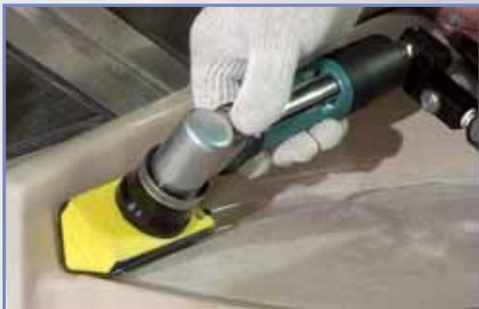
**58000** La levigatrice Dynafine™ «Backsplash» include un platorello con un raggio di 10 mm (3/8"), ideale per raggiungere angoli, scanalature e aree convesse. Utilizzata per la levigatura di precisione, il ritocco di rivestimenti in gelcoat e la riparazione generale delle macchie, è un utensile indispensabile per ogni cantiere nautico!
