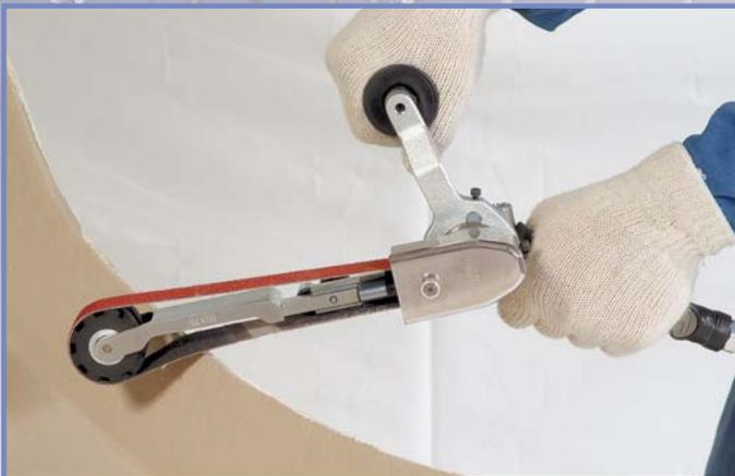
**15300 : Dynaflex® III.** Cet outil à bande abrasive fonctionne avec le bras de contact 15375, ce qui permet de finir et de polir avec le brin mou de la bande. Idéal pour les bords rugueux des pièces tronçonnées. Cet outil accepte également une large gamme de bras de contact supplémentaires lui permettant de s'adapter à de nombreux autres travaux.
