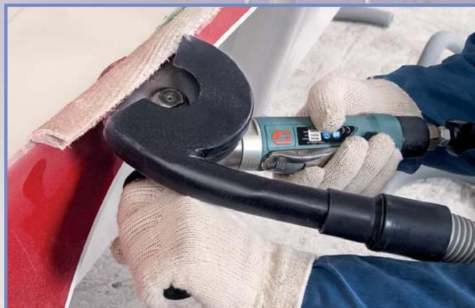
**52438 : Outil de tronçonnage à meule diamant avec aspiration.** Entraîne des disques de tronçonnage diamant de 127 mm (5 po) de diamètre (vendus séparément), pour le tronçonnage des surplus épais de fibre de verre ou de fibres posées au pistolet. Son capot spécial d'aspiration dirige la poussière et les débris vers une source d'aspiration (en option).
