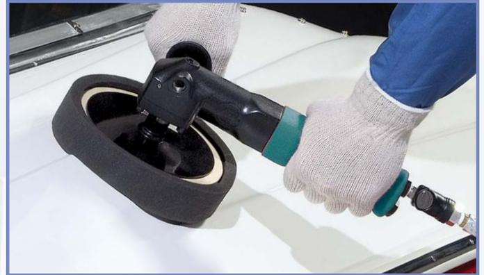
**51459 : Lustreuse Dynabrade.** Pour le lustrage et l'ultime finition. Elle tourne à la vitesse optimale de 2500 tr/min, ce qui lui permet de polir les rayures, PAS de les fondre dans la surface comme le font souvent les lustreuses plus rapides. Dotez notre lustreuse à basse vitesse et à haut couple d'un feutre à polir en mousse ou d'une bonnette en laine (vendus séparément) et vous obtiendrez un système de finition rapide et efficace !
