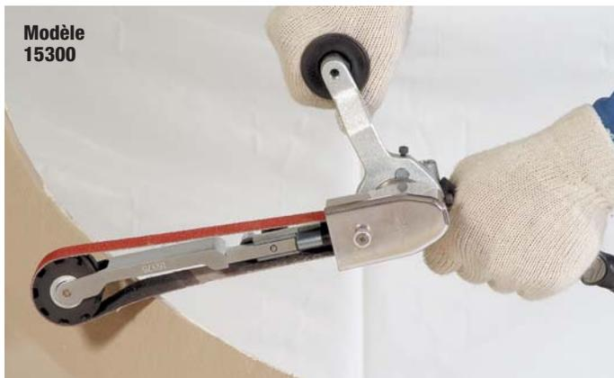
La Dynafile® III munie du bras de contact 15375 (vendu séparément) permet d'effectuer la finition avec le brin mou de la bande. Ce bras nécessite l'usage de bandes de 610 mm (24 po) de long.
