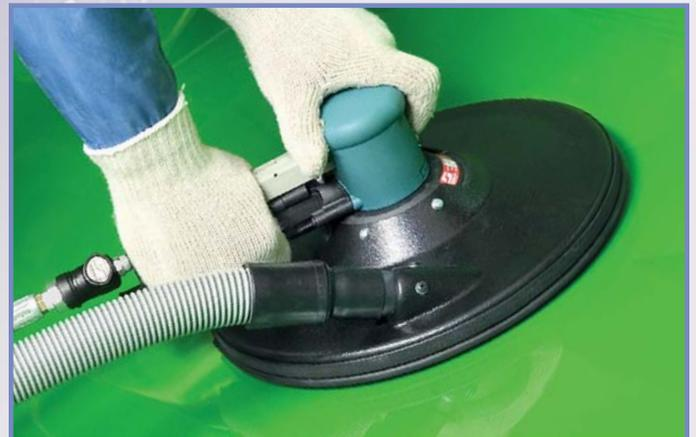
**58041 : Surfaceur.** Offre une surface de travail géante de 279 mm (11 po) de diamètre, parfaite pour le « profilage » et le ponçage de moules et de mandrins. Couvre une surface PLUS grande en MOINS de temps, permettant ainsi d'égaliser facilement des surfaces importantes afin d'obtenir un fini miroir. Ponceuse excentrique de 279 mm (11 po) également disponible !
