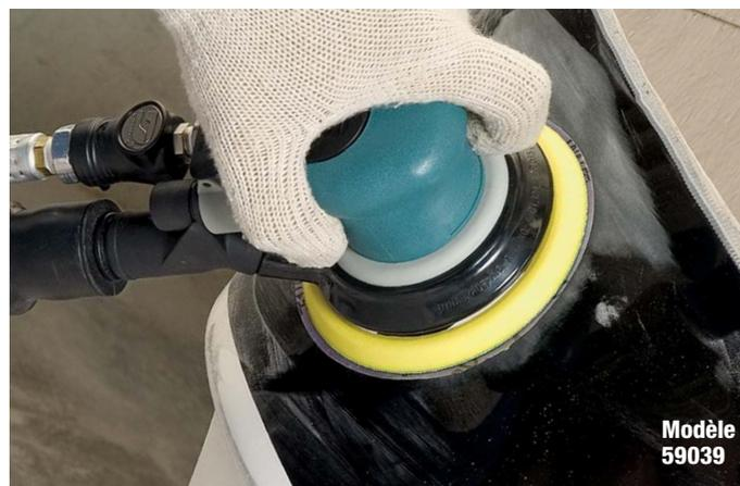
La Dynorbital-Spirit® est idéale pour la réparation sur enduit gélifié et enduit lustré. Elle est également parfaite pour enlever les marques d'infiltration d'encre sur la fibre de verre.
