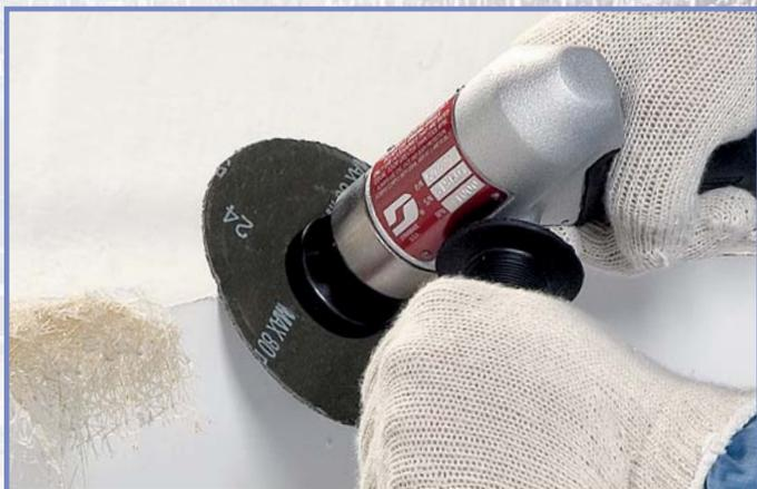
**50321 : Meuleuse à disque Revolver.** Enlève facilement l'excès de fibre de verre. L'outil peut également être utilisé pour frotter la surface de la résine du bateau afin de la préparer au collage de la mousse de flottaison.
