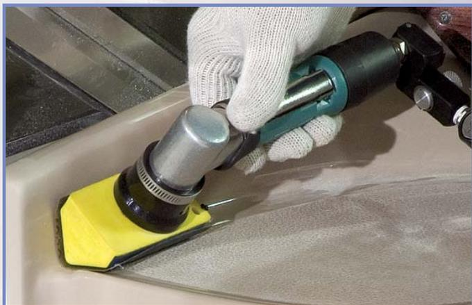
**58000 : Ponceuse pour « dossierer » Dynafine®.** Livrée avec un plateau de ponçage de 10 mm (3/8 po) de rayon, elle est idéale pour poncer dans les recoins, les gorges et les surfaces convexes. S'utilise pour le ponçage de finition, les retouches sur enduit gélifié et la réparation localisée – un outil utile pour tous les ateliers navals !
