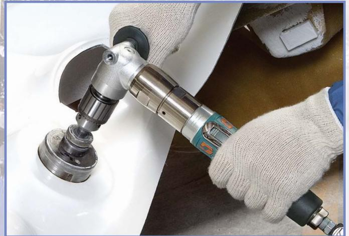
**53143 : Perceuse à angle droit.** Cette perceuse est assez puissante (745 W/1 Hp) pour entraîner des scies-cloches diamant (en option) pour le perçage rapide de gabarits de tableaux de bord ou la création d'autres ouvertures.
